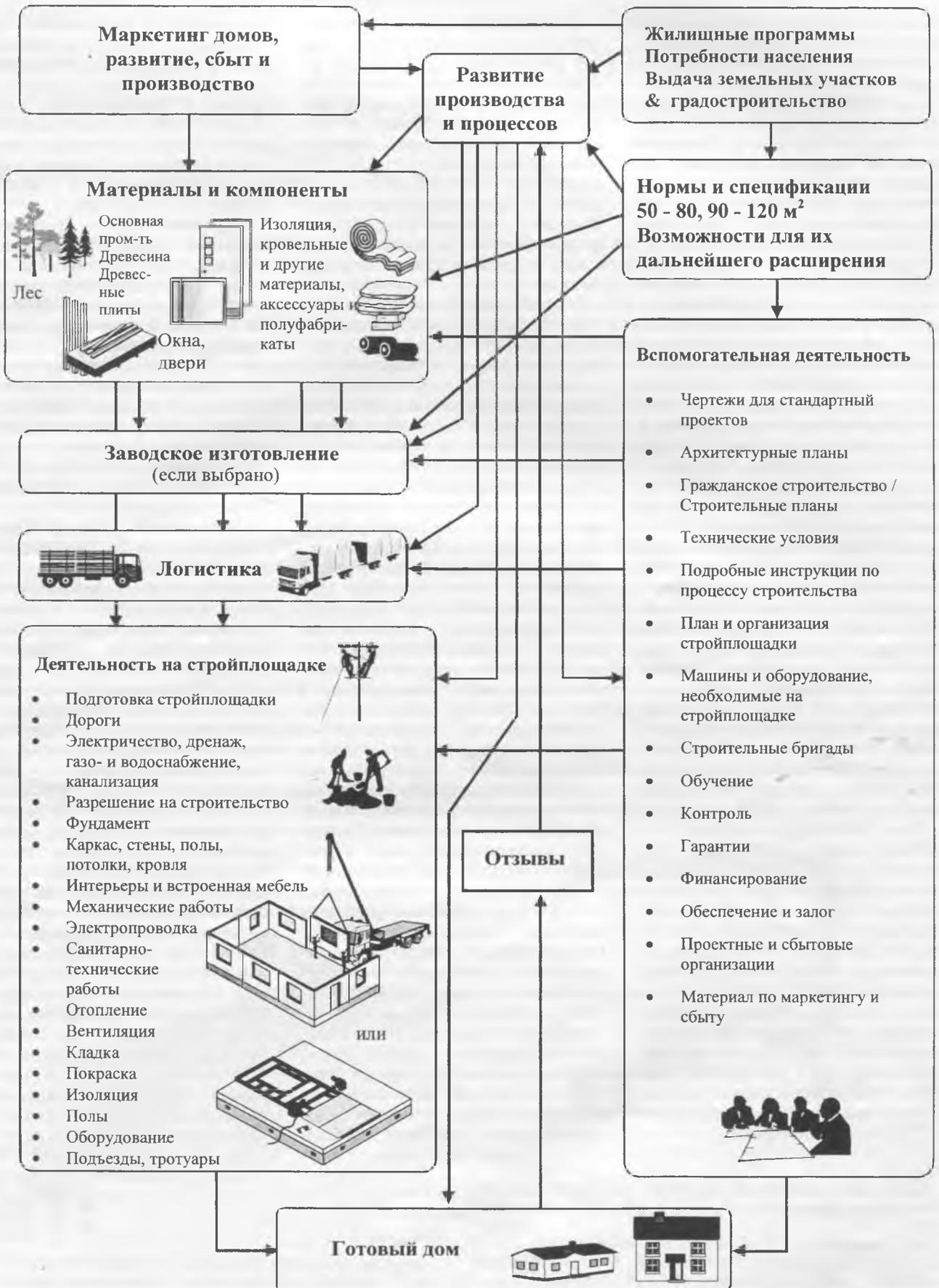
Рис. 4. Схема процесса деревянного домостроения
