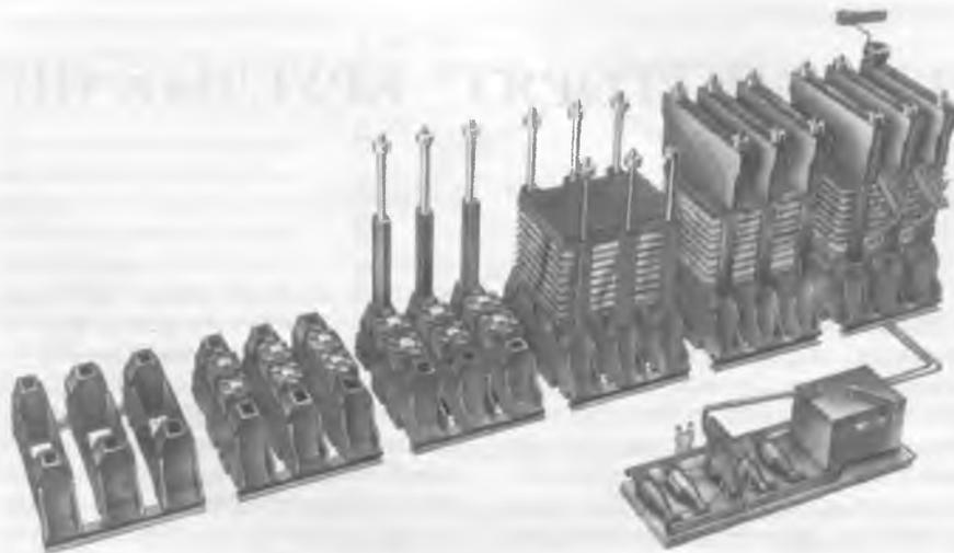
Рис. 3. Пресс для производства ДВП
