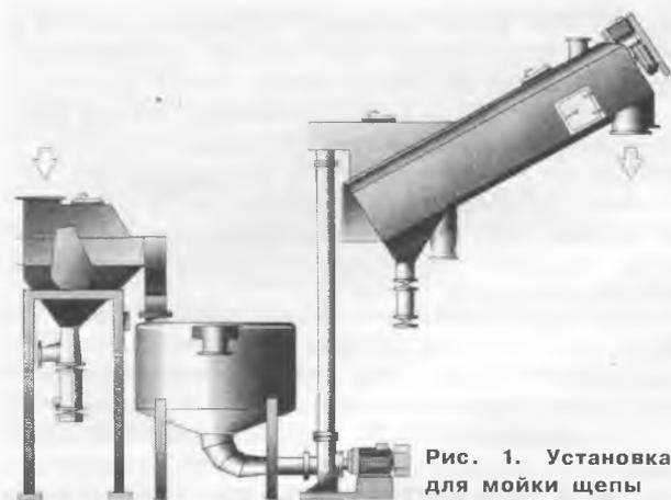
Рис. 1. Установка для мойки щепы
