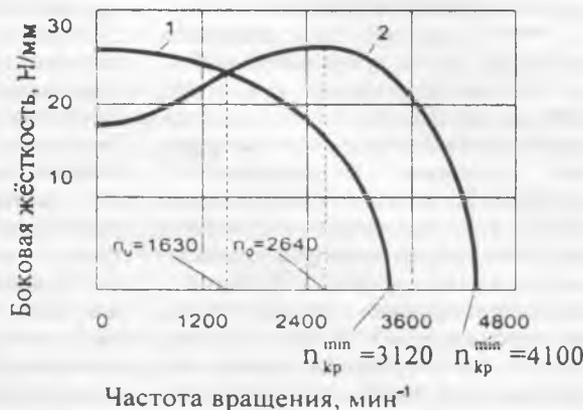
Рис. 2. Графики зависимости изгибной жёсткости диска пилы диаметром 500 и толщиной 2,2 мм от частоты вращения:
