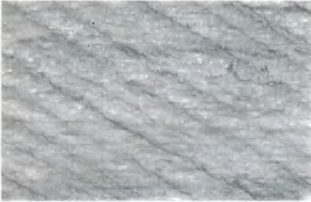
Рис. 1. Поверхность древесины бука после механического резания параллельно волокнам (М 1:12,3)
