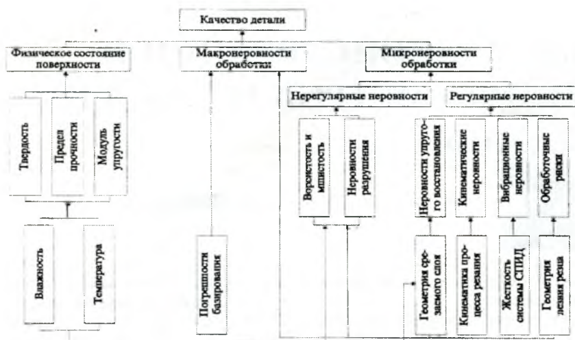
Рис. 2. Система технологических факторов, определяющих качество поверхности детали
