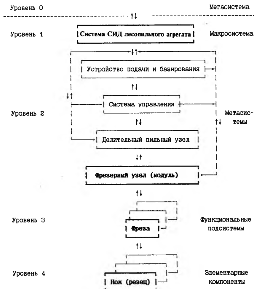
Рис. 1. Структурная схема системы СИД лесопильного агрегата
