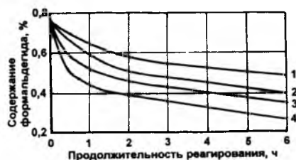
Рис. 1. Зависимость массового содержания свободного формальдегида в связующем от продолжительности реагирования при различных величинах массового содержания БСМК:
