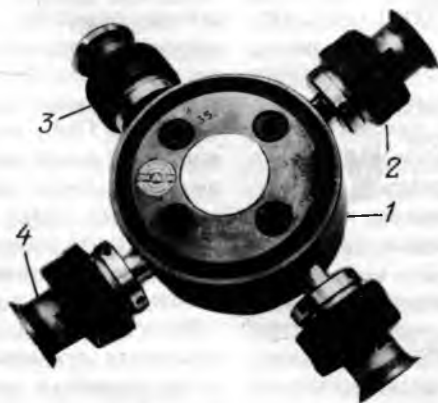
Рис. 1. Общий вид фрезы: 1 — корпус фрезы; 2 — верхний ротор; 3 — нижний ротор; 4 — режущие диски
