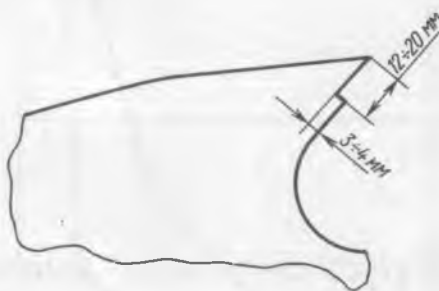
Рис. 1. Зуб пилы с оформленной канавкой
