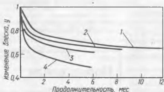
Рис. 3. Прогнозируемое изменение блеска покрытий при t=20^{\circ}\text{C} и \phi=80\% :
