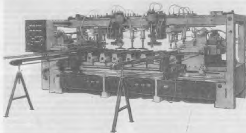
Рис. 1. Станок DUBM/D 2500/3 для сверления отверстий в мебельных щитах
