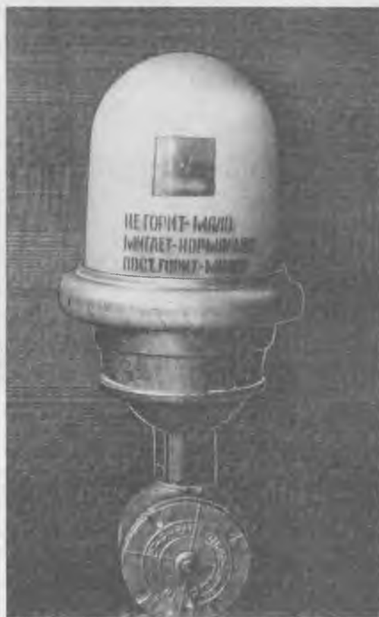
Рис. 1. Индикатор контроля загрузки двигателя
