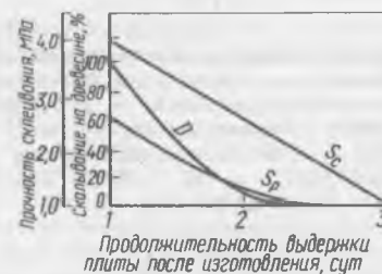
Рис. 3. Влияние продолжительности выдержки ДСП после изготовления на прочность склеивания и характер разрушения клеевого шва
