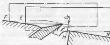
Рис. 3. Схема поворота частицы при срезании стружки
