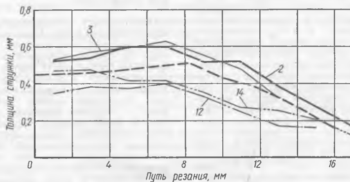
Рис. 4. Изменение толщины стружки, срезаемой ножами с начальным затуплением
