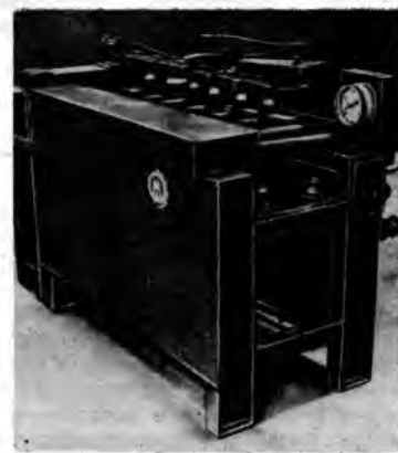
Рис. 7. Станок для склеивания отрезков ДСП в щиты с помощью термопластикового клея
