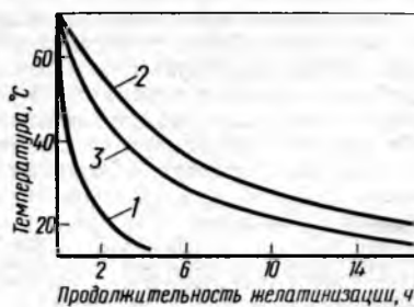
Рис. 2. Зависимость желатинизации карбамидных смол от температуры при введении в них 15 % модификатора РМ-1 и 1 % хлористого аммония:
