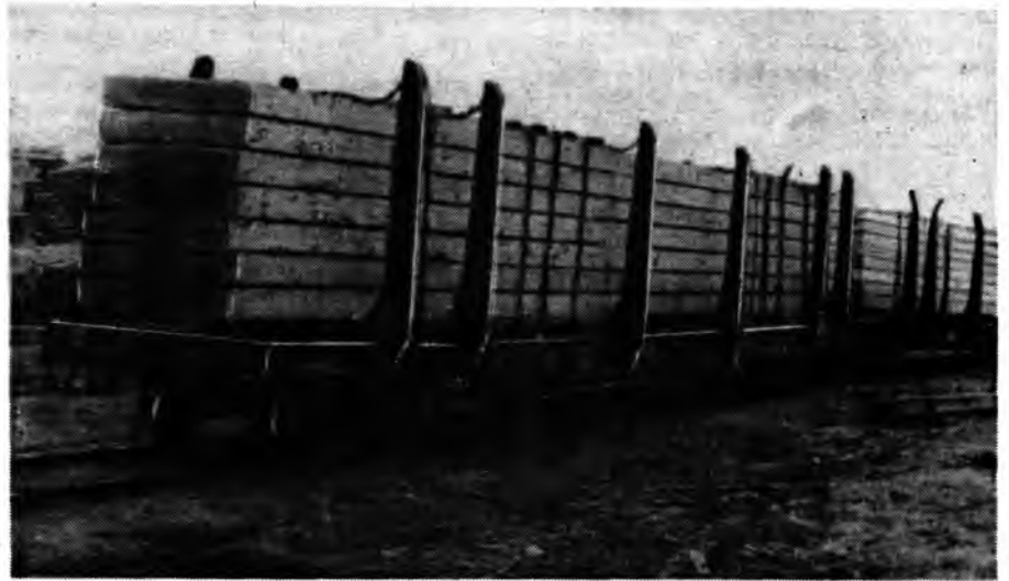
Платформа-хлыстовоз, загруженная деревянными клееными балками длиной 24 м
