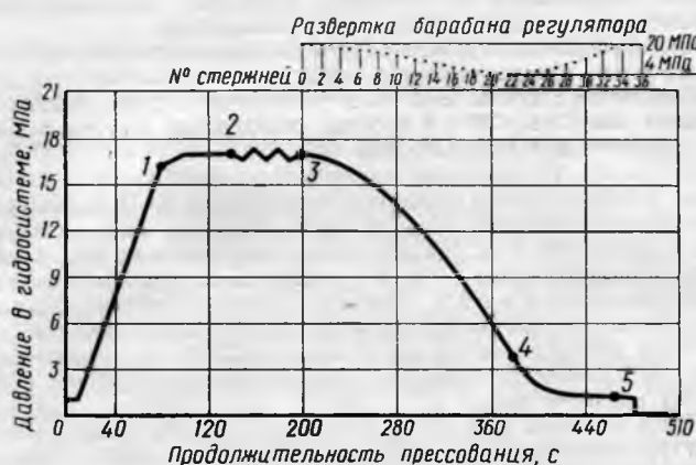
Рис. 1. Диаграмма прессования с плавным снижением давления
