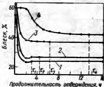
Рис. 1. Изменение блеска в процессе отверждения пленок высыхающих составов:
