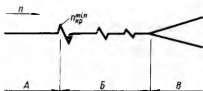
Рис. 2. Изгибные колебания диска пилы при разгоне до предельного состояния (разрушения)
