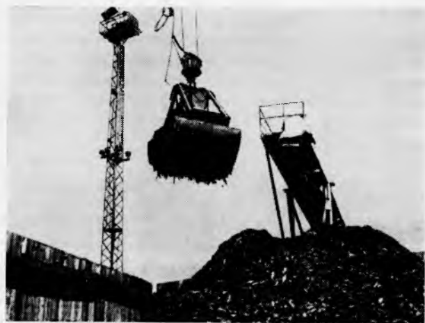
Рис. 1. Отгрузка лиственничной коры виброгрейфером ВРМ-5
