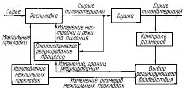
Рис. 4. Схема системы регулирования точности размеров пиломатериалов
