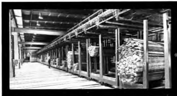
Сортировочный транспортер сортировочной установки по сечениям и тележка с амортизацией сбрасывания пиломатериалов.
