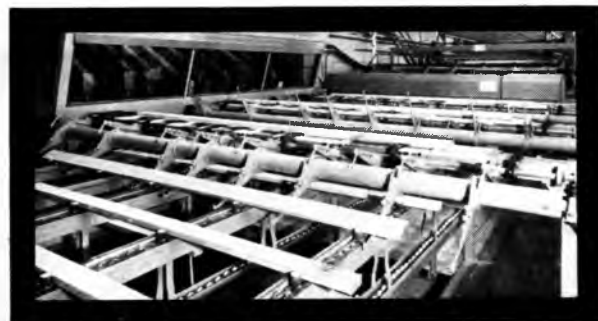
Сортировочный стол торцовочной установки с сортировочным блоком. Рядом с линией кабина сортировщиков. На заднем плане триммерная установка. Конструктивная скорость установки 90 шт/мин.
