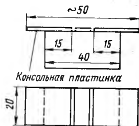
Рис. 3. Образец для испытаний с поперечными пропилами облицовки
