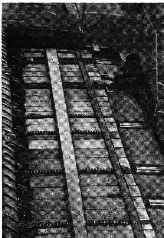
Механизм поштучной выдачи досок Л-60А
