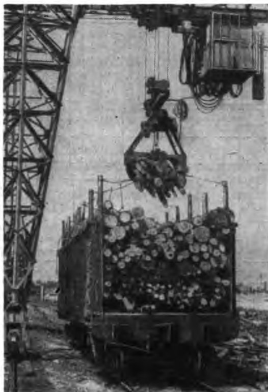
Рис. 1. Выгрузка сырья консольно-козловым краном ККУ-7,5
