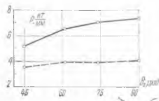
Рис. 2. Зависимость максимальной (сплошная линия) и средней (пунктирная линия) удельной силы резания от угла резания матрицы
