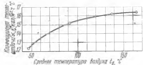
Рис. 3. График для определения коэффициента теплоотдачи
