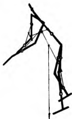
Рис. 2. Поза станочника при обработке брусковой детали на фуговальном станке и схема расчета центра тяжести его тела
