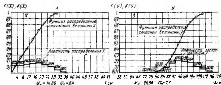
Рис. 1. Функции распределения и плотность распределения: а — ширины рабочей зоны станка; б — высоты рабочей поверхности станка от уровня пола
