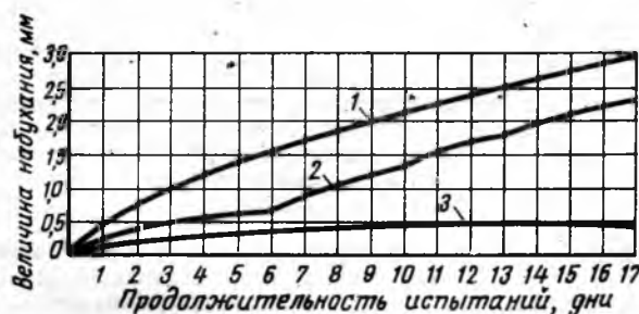
Рис. 4. Деформация поверхности древесностружечных плит при набухании ее под влиянием водяных паров:
