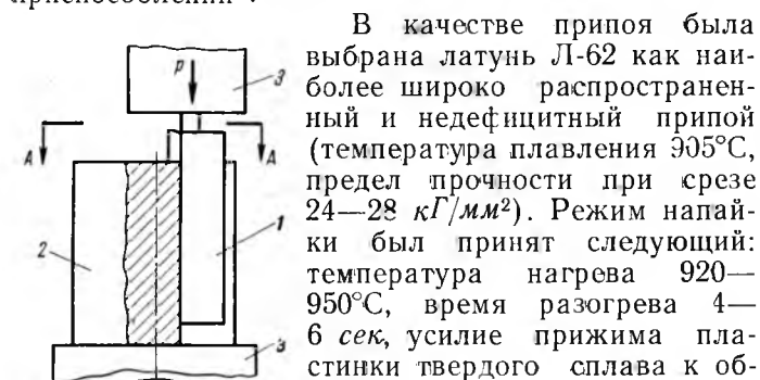
Рис. 1. Схема испытания паяного шва на срез:
