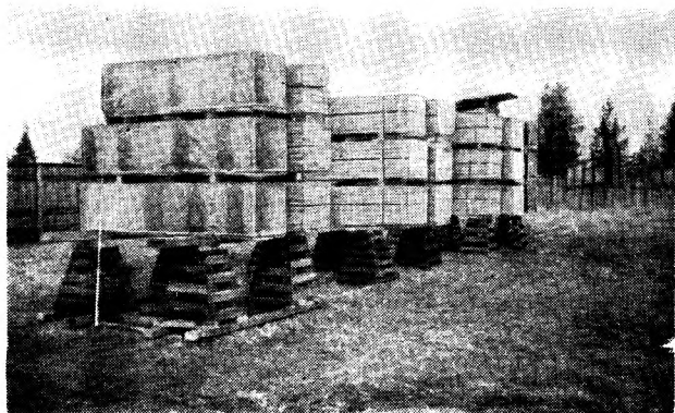
Рис. 1. Хранение сухих пиломатериалов в водозащитных обертках на открытом складе
