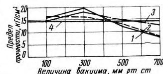
Рис. 3. График зависимости предела прочности на разрыв при растяжении перпендикулярно плоскости плиты от величины и времени включения вакуума:
