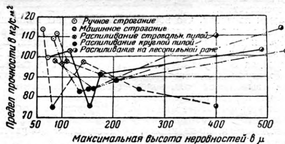
Рис. 1. Зависимость предела прочности клеевого шва при скалывании от чистоты поверхности древесины при запрессовке с удельным давлением 10 кг/см²
