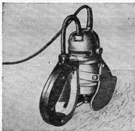
Рис. 6. Ручной переносный станок для удаления дефектов в шпоне
