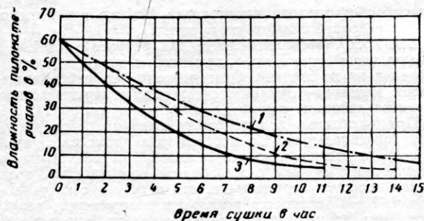
Рис. 2. Влияние скорости циркуляции воздуха в сушилке на скорость сушки пиломатериалов (температура по сухому термометру 115°, по влажному 95°):
