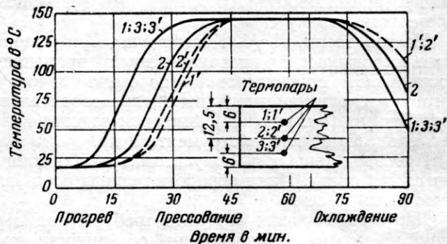
Рис. 3. Температурный график прогрева при склеивании 25-миллиметровых фанерных плит в промежутках пресса Н и К (см. рис. 2):
