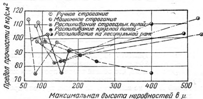
Рис. 2. График зависимости предела прочности клеевого шва при скалывании от чистоты поверхности древесины при запрессовке с удельным давлением 10 \text{кг/см}^2
