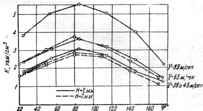
Рис. 4. Зависимость удельной работы резания при толщине стружки 1 мм от угла встречи при различных скоростях резания
