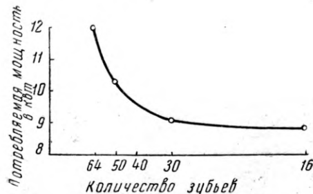
Рис. 2. Расход мощности при пилении в зависимости от числа зубьев пилы (материал — сухая сосна) — по данным ЦНИИМОД
