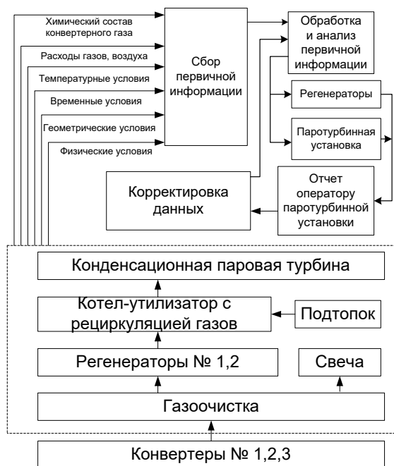
Рис. 1. Функциональная схема оценки технологических параметров УУ КГ
