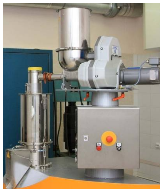
Рис. 1. Пресс-гранулятор Amandus Kahl, тип 14-175
