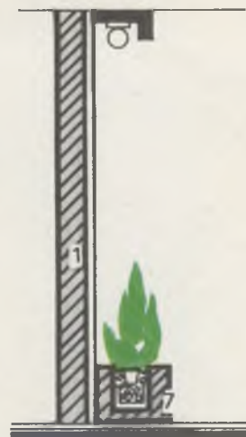
РАЗРЕЗ СТЕНЫ СО СТАЦИОНАРНОЙ ЦВЕТОЧНИЦЕЙ
