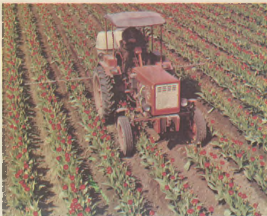
Обработка тюльпанов ядохимикатами из опрыскивателя ОП-400 на тракторе Т-25А
