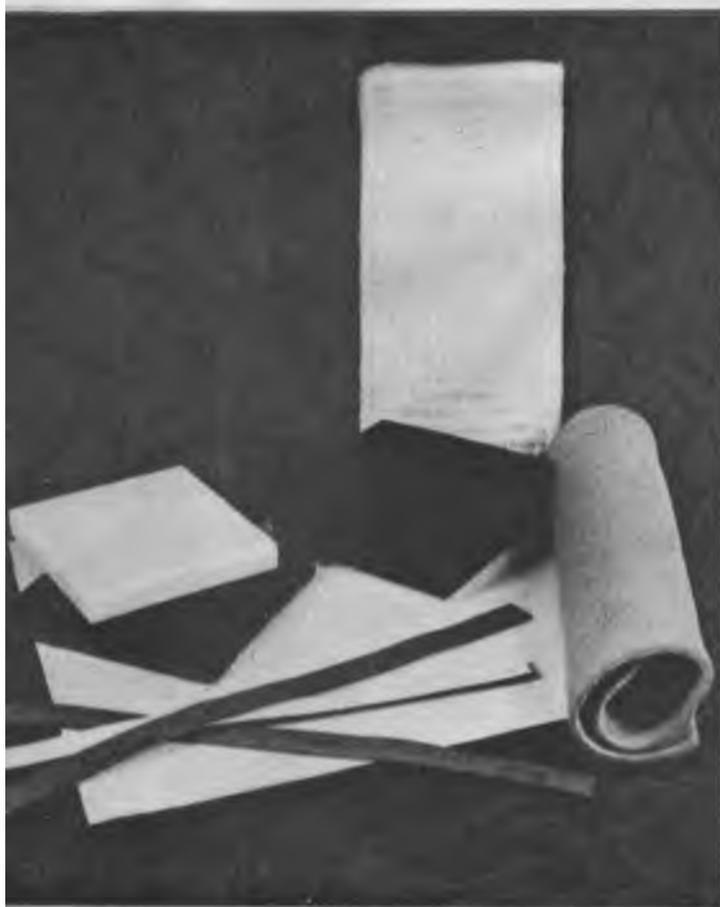
Материалы теплозащитного покрытия «Бурана».
