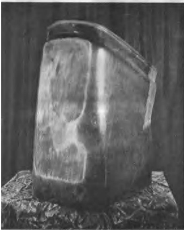
Секция носка крыла из материала «углерод—углерод».
