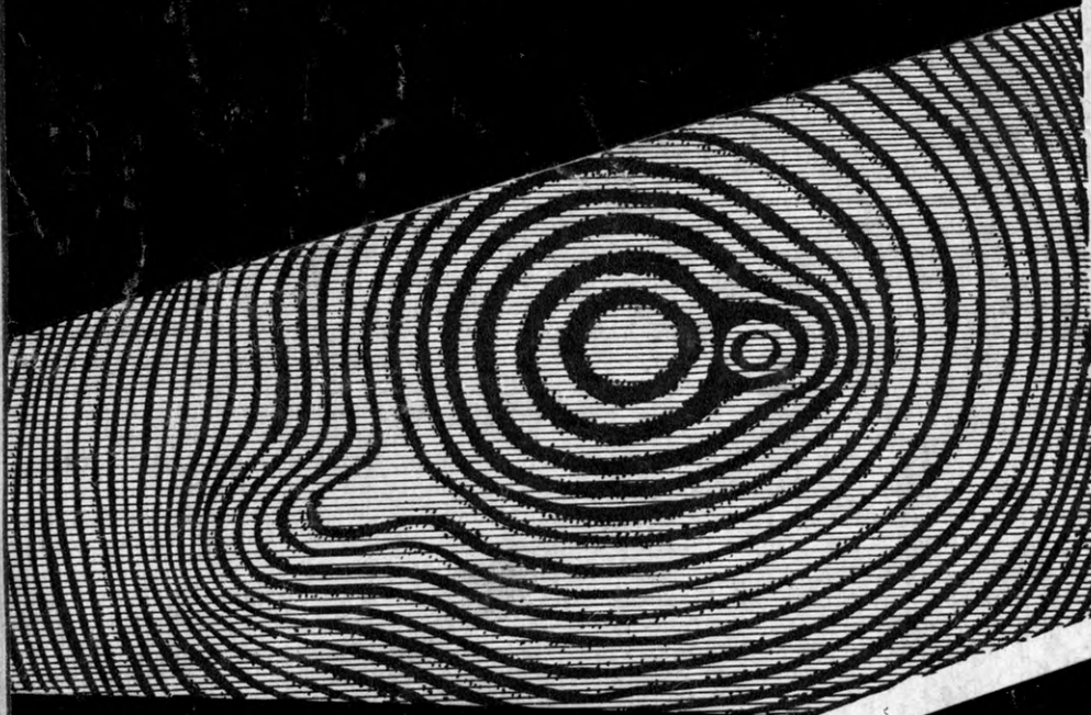
ИНТЕРФЕРЕНЦИОННАЯ КАРТИНА ЗОН КРЫЛА САМОЛЕТА С РАЗЛИЧНЫМИ ПРОЧНОСТНЫМИ ХАРАКТЕРИСТИКАМИ.
