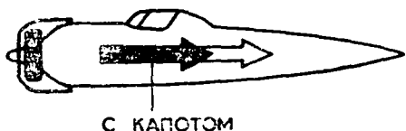
Рис. 3. Капотирование и дефлектирование двигателей уменьшило сопротивление фюзеляжа с мотором на 25—40%
