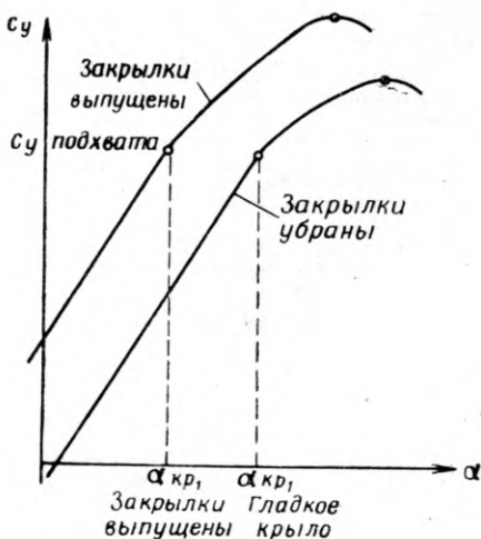
Изменение критического угла атаки при выпущенных закрылках.
