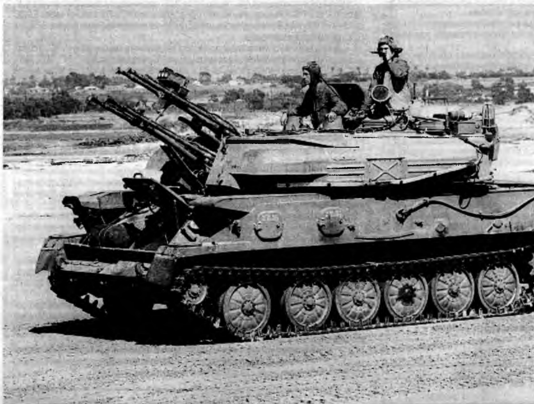
ЗСУ-23-4 "Шилка" - зенитная самоходная установка, серийное производство начато в 1964 году. Вооружена счетверённой автоматической 23-мм пушкой. Темп стрельбы установки - 3400 снарядов в минуту.
