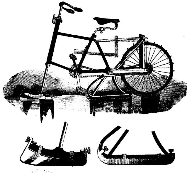
Между рулевымъ полозомъ и заднимъ колесомъ установленъ, подъ сидѣніемъ, другой полозъ, съ гладкою нижнею поверхностью. Единственное заднее колесо, вместо резиновой шины, снабжено зубцами, которые врѣзываются въ ледь или хорошую зимнюю дорогу и даютъ велосипеду поступательное движение впередъ.
