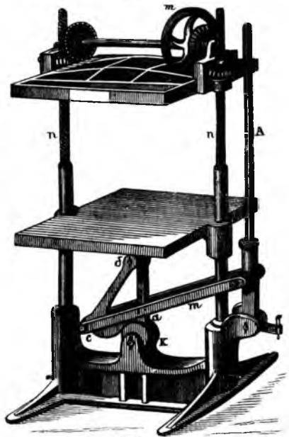
Паковальный желѣзный прессъ сильнаго давленія, дѣйствующій посредствомъ рычага.
