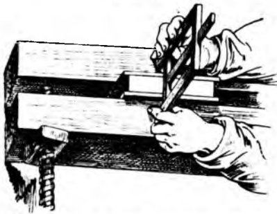
Провѣрка положенія книги въ прессѣ посредствомъ затла.
