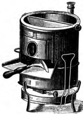
Желѣзная печь для варки клея, а также и для нагрѣванія служащихъ для тисненія инструментовъ.
