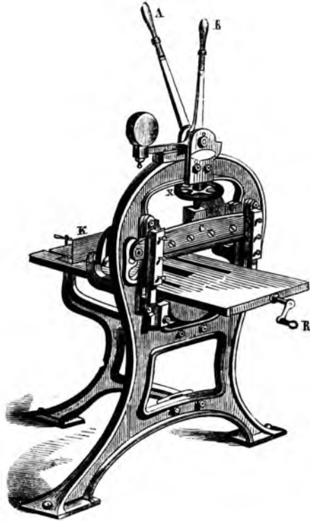
Бумаго-рѣзальная машина. дѣйствующая посредствомъ рычага.
