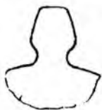
Рис. 4.20. Вид подрезанного зуба
