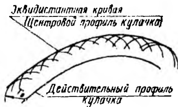
Рис. 3.10. Построение эквидистантной кривой
