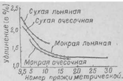
Рис. 55. Изменение удлинения пряжи в зависимости от ее номера
