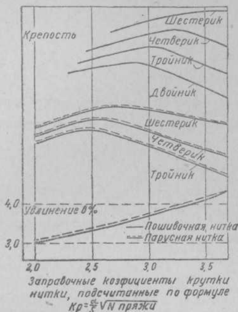
Рис. 137. Изменение крепости и удлинения нитки в зависимости от крутки нитки
