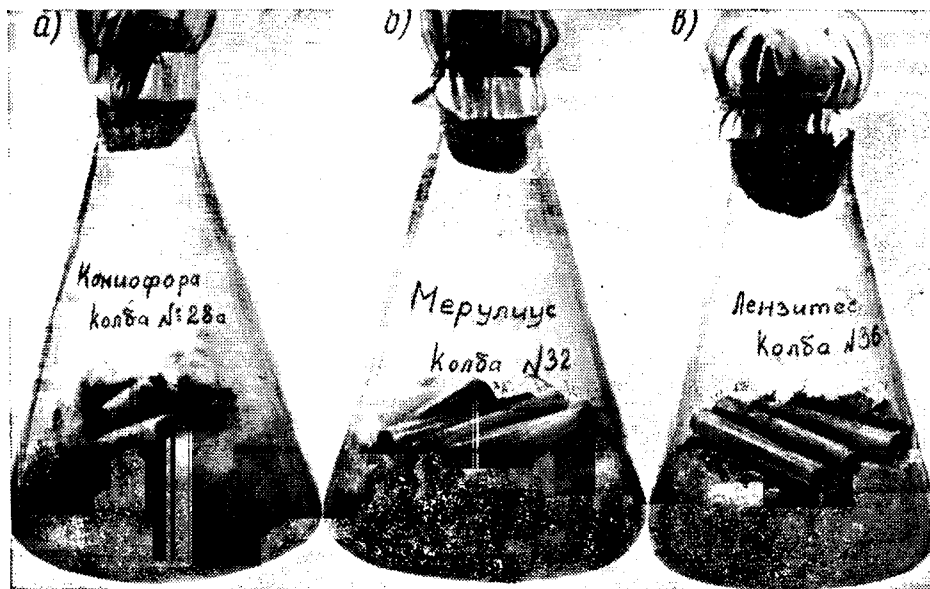
Рис. 15. Колбы с образцами камыша, пропитанными раствором пентахлорфенолята натрия а — концентрация раствора 0,5% — образцы обросли мицелием гриба; б — концентрация раствора 1% — образцы свободны от поражения; в — концентрация раствора 5% — образцы свободны от поражения
