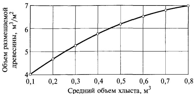
Рис. 10.1. Зависимость объема древесины, размещаемой в пределах полезной площади переднего коника, от среднего объема хлыста
