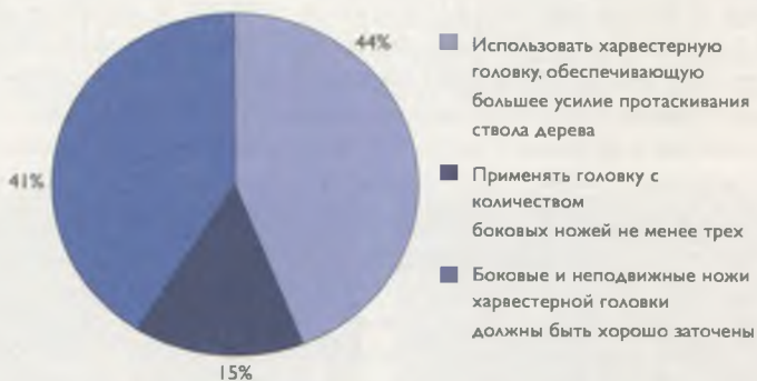
Рис. 5.16. Способы снижения или полного исключения не полностью срезанных сучьев
