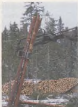
Рис. 5.24. Нарушения при выполнении погрузочных и разгрузочных операций
