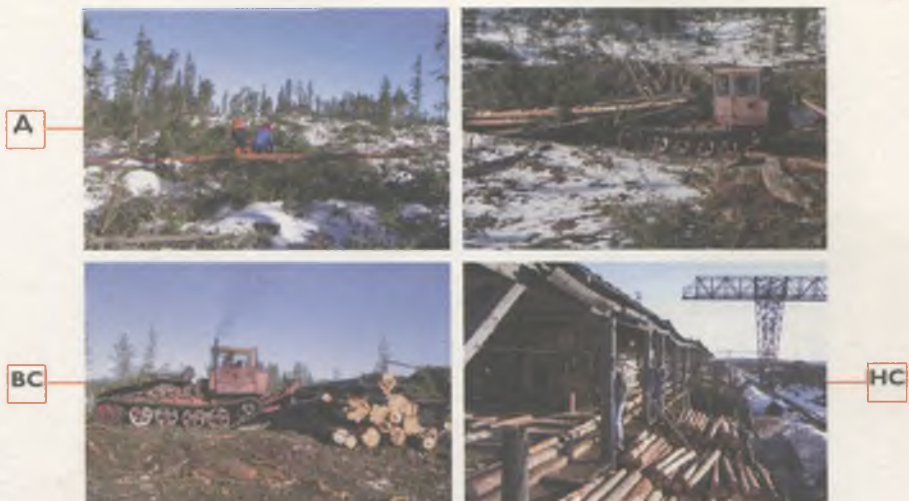
Рис. 5.3. Измерения при заготовке хлыстами (бензопила + трелевочный трактор): Д – хлысты на делянке, ВС – хлысты на верхнем складе (погрузочной площадке), НС – сортименты на нижнем складе
