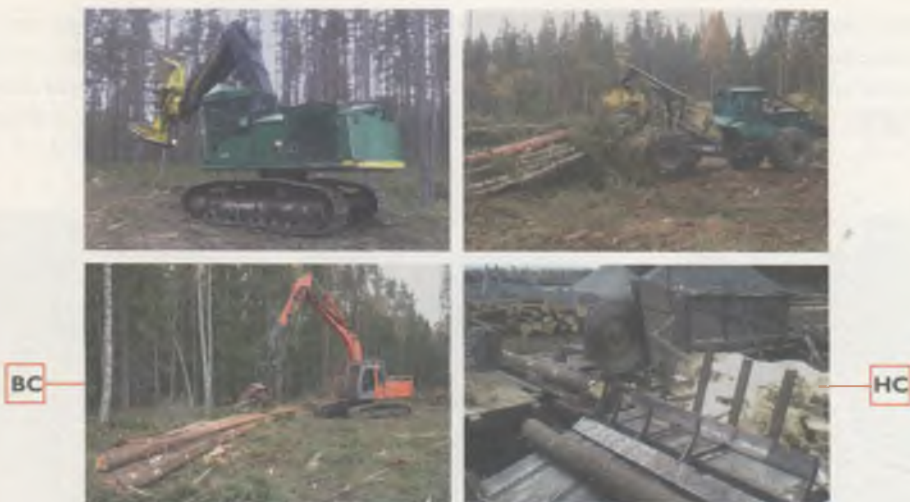
Рис. 5.5. Измерения при механизированной заготовке деревьями (валочно-пакетирующая машина + трелевочный трактор): ВС – хлысты на верхнем складе (погрузочной площадке); НС – сортименты на нижнем складе
