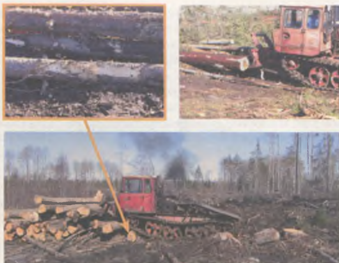
Рис. 5.19. Нарушение операции штабелевки хлыстов
