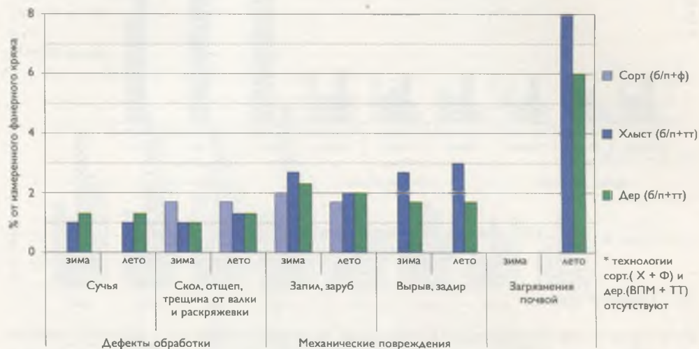
Рис. 5.8. Дефекты и загрязнения почвой березового фанерного кряжа в зимний и летний сезоны
