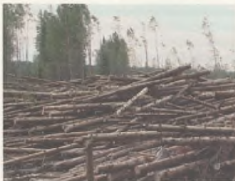
Рис. 5.26. Размещение штабеля круглых лесоматериалов на верхнем складе (погрузочной площадке) без подштабельного основания
