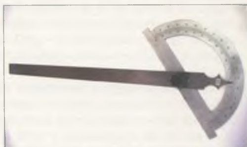
Рис. 4. Угломер на передвижной планке для дополнительного измерения скоса пропила
