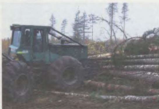
Рис. 5.25. Нарушение операции штабелевки деревьев
