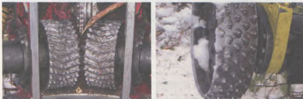
Рис. 5.22. Приводные стальные вальцы с изношенной ошиповкой
