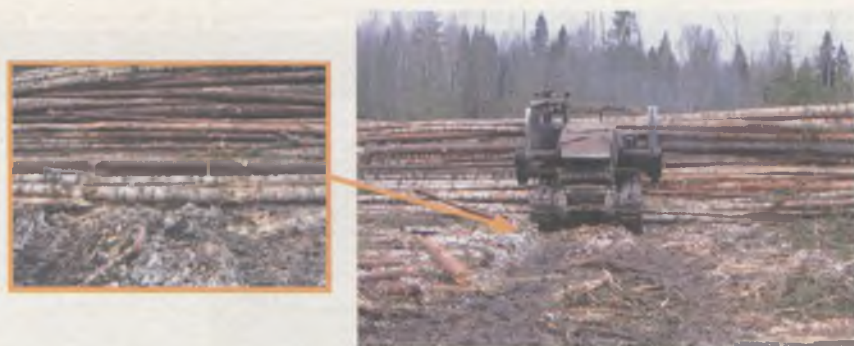
Рис. 5.21. Нарушение операции формирования пачки хлыстов
