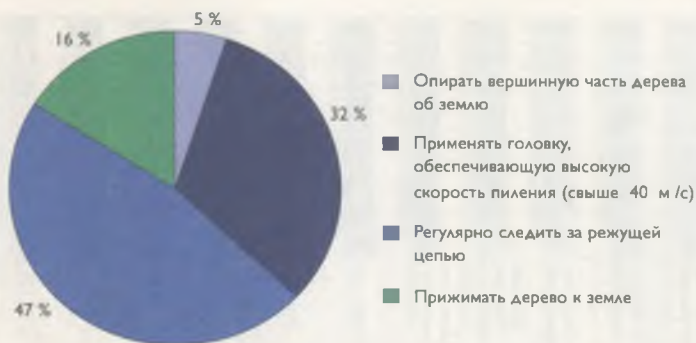
Рис. 5.17. Способы исключения образования трещин на торцах сортиментов во время раскряжевки ствола дерева харвестерной головкой
