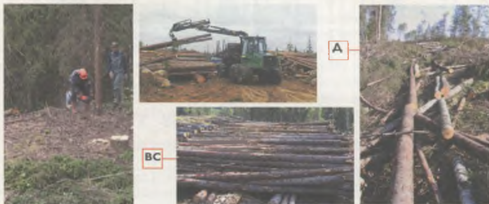
Рис. 5.1. Измерения сортиментов при заготовке механизированным сортиментным методом (бензопила + форвардер): А – на делянке, ВС – на верхнем складе (погрузочной площадке)
