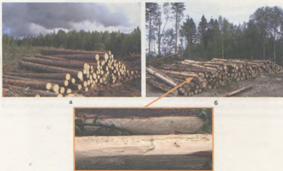
Рис. 5.23. Сортименты, заготовленные харвестером с правильно (а) и неправильно (б) отрегулированным сучкорезно-протаскивающим механизмом харвестерной головки
